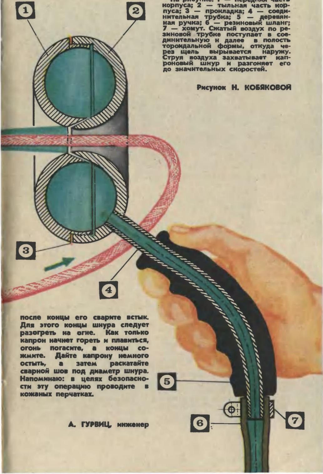
после концы его сварите встык. Для этого концы шнура следует разогреть на огне. Как только капрон начнет гореть и плавиться, огонь погасите, а концы сожмите. Дайте капрону немного остыть, а затем раскатайте сварной шов под диаметр шнура. Напоминаю: в целях безопасности эту операцию проводите в кожаных перчатках.
