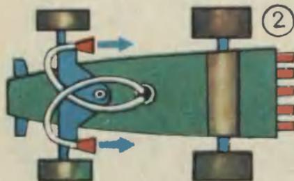
Вид снизу. Концы трубок пропущены сквозь отверстие в раме модели и надеты на воздуховоды, установленные на передней оси.
